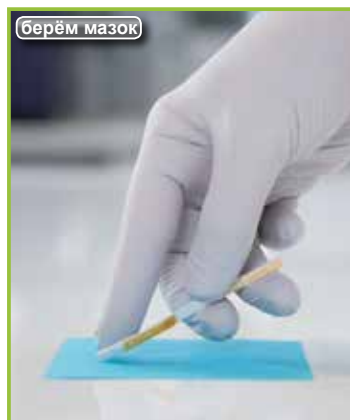
Рисунок 1: RIDA®QUICK Gliadin Тестовые стрипы можно использовать напрямую для взятия мазка
